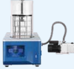
Taponamiento Adecuado para liofilizar y tapar muestras en viales
