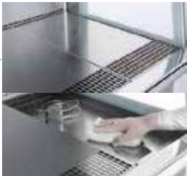
La superficie de trabajo compartimentada es fácil de esterilizar y limpiar.
