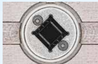
Transmisor de mems con base de silicio
